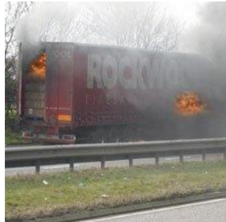
Zelf ontbrandende steenwol in vrachtwagen. Alles brandt, ook steenwol!
